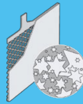
Uten Carbon Boost® Platene er dekket av sulfat
