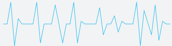
Tipico andamento dello Stato di Carica durante un viaggio con un sistema Start-Stop.
