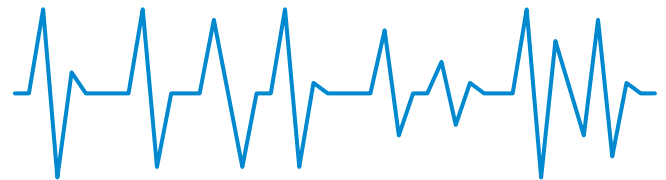
Schéma typique de l'état de charge pendant un trajet avec le système Start-Stop
