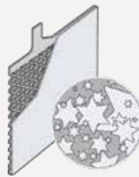
OHNE CARBON BOOST Sulfatierte Platten
