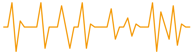
Typisches Ladezustandsmuster während einer Fahrt mit Start-Stop-System
