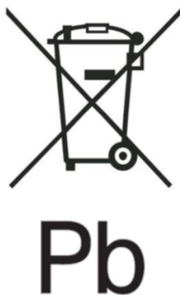
Figure 2 – Exemple de marquage avec le symbole de collecte séparée conformément à l'annexe VI partie B et avec le symbole chimique 'Pb' pour la teneur en métal lourd Pb conformément aux articles 13.4 et 13
